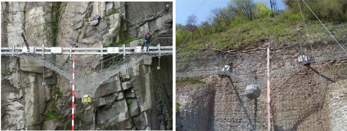
Figure 67 Pamje nga testi dinamik i goditjes ne nje moster te barrieres mbrojtese.
